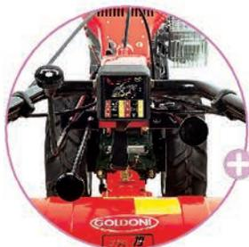
+ Dispositif de verrouillage de la marche arrière avec la prise de force enclenchée dans les opérations de fraissage.
