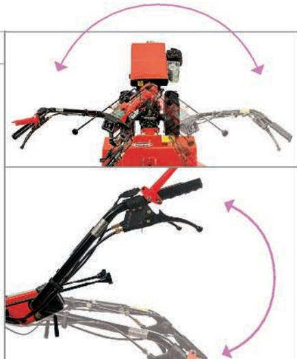
+ Le réglage en hauteur du mancheron (9 positions) permet un confort dans l'utilisation du motoculteur et pour tout type d'opération. Un réglage latéral (5 positions) est également prévu permettant à l'utilisateur de ne pas piétiner le sol déjà préparé. La réversibilité du mancheron à 180°, s'effectue par une commande simple et rapide, permettant d'adapter des accessoires frontaux tels que: faucheuse, tondeuse, fraise à neige, etc.
