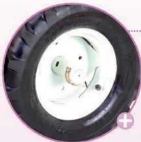
+ La largeur extérieure des roues et la voie sont réglables. Les réglages adaptent la machine aux différentes cultures.
