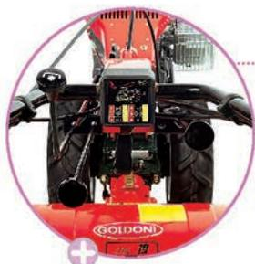
⊕ Dispositif de verrouillage de la marche arrière avec la prise de force enclenchée dans les opérations de fraissage.
